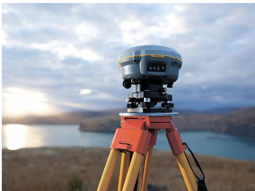
20 Сурет – GNSS Trimble R8 қабылдағыш
