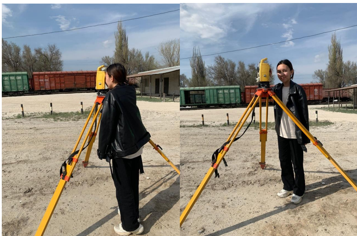
19 Сурет – Объектіде Trimble m3 DR 5" тахеометрімен жұмыс істеу
